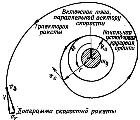
Рис. 2.10. Движение по спирали, близкой к окружности, с малым ускорением около центрального тела, создающего гравитацию
